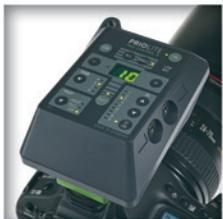
**Le nouveau système de synchronisation Priolite Hot Sync contrôle les temps d'éclair jusqu'à 1/8.000 seconde. On le reconnaît à son socle vert.**
