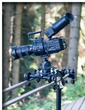
La voie se monte à l'aide des rails Combitube et une série d'accessoires. Elle peut aller de 90 cm à plusieurs mètres de long. Le chariot peut aussi se transformer pour être utilisé sur un sol plat. Dans ce cas, les paires de roulettes fixées à l'avant et à l'arrière peuvent tourner pour négocier des virages.
