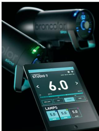
La version S affiche une température de couleur constante (5.500°K) sur l'ensemble de la plage de réglage (9 stops à un minimum de 2 joules). Sa plus courte durée d'éclair est de 1/13.000 sec. à t 0,5. Ce modèle peut réaliser jusqu'à 50 éclairs en rafale et les flashes Siros sont radio synchronisés via Broncolor RFS 2.1 ou PocketWizard qui donne accès au monde HyperSync.
