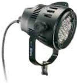
Système d'éclairage unique équipé de 49 lampes LED peu gourmandes en énergie qui génèrent une luminosité comparable à celle d'une lampe halogène de 400 watts. Elles peuvent brûler 20.000 heures et sont très résistantes. Dans leur boîtier compact 'Splash Proof' (255x190x188 mm), elles peuvent également être utilisées à l'extérieur (classe IP 54).
