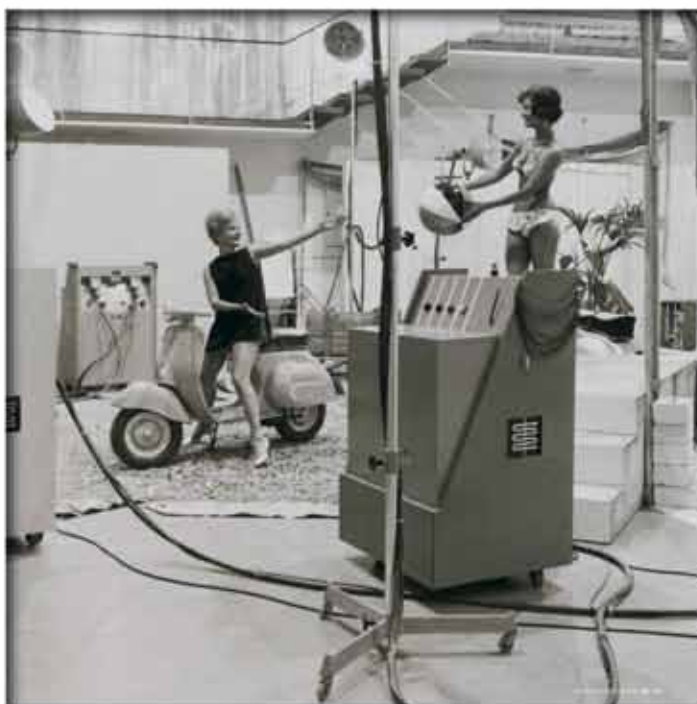
A l'avant plan, un générateur Broncolor Type S 101, un colosse qui affiche une puissance de 10.000 joules. Il a été lancé en 1959 et retiré de production dix ans plus tard. Prise de vue de 1961, réalisée dans un des studios photo de l'imprimerie Maul & Co. à Nuremberg - Allemagne.
