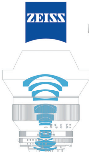
Dwarse doorsnede van een modern objectief, het Distagon 15 mm. Zonder krachtige rekencomputer zou de berekening van de slijpvlakken van de 16 lenzen maanden, zo niet jaren in beslag nemen.
