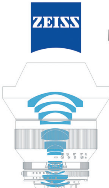
Coupe transversale d'un objectif moderne, le Distagon 15 mm. Sans ordinateur puissant, le calcul des surfaces de polissage de ses 16 lentilles aurait pris des mois, voire des années.
