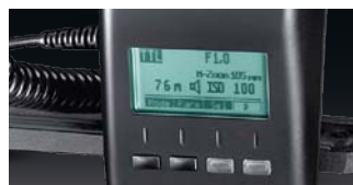
Écran par matrice de points à cristaux liquides à rétroéclairage intégré à l'appareil de commande
