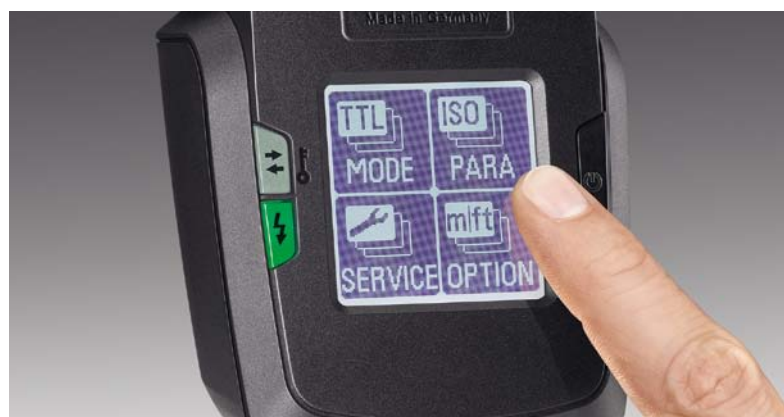
Ecran tactile rétroéclairé avec fonction de rotation
