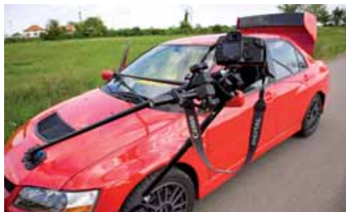
Prise de vue d'une voiture en marche: Eléments COMBITUBE*, ventouses, petit trépied ASNIO et tête de trépied SUPERBALL M-2
