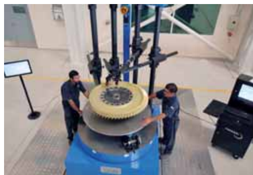
Supervision tactile du balourd de composantes de haute précision: quatre pieds à colonne comme cadre support pour les capteurs sensibles
